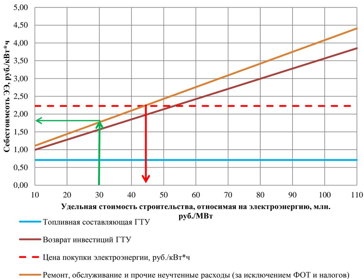
**Рисунок 5.14 – Соотношение топливной и прочих составляющих в цене электроэнергии ГТУ**
